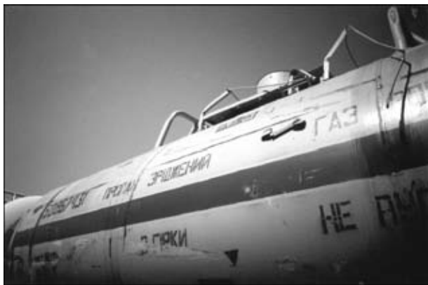
Рис. 3. Железнодорожная цистерна после опрокидывания
