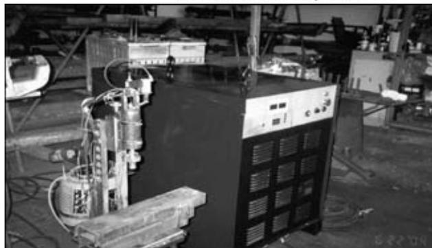
от конструкции, возбуждения дуги и поддержания постоянной высоты отрыва во время горения дуги. Для подключения пистолета к установке применяются кабель КОГ-35 общим сечением  $105 \text{ мм}^2$  длиной до 20 м. Сварочный пистолет позволяет обеспечить различные скорости осадки шипа в сварочную ванну для получения оптимального качества сварки. Один источник питания может обеспечить работу от 1 до 4 пистолетов.
