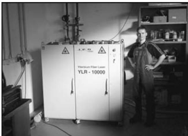
Эти технические характеристики, а также малые габаритные размеры лазера (ширина 1,5 м, высота 1,5 м, глубина 0,8 м) и простое электрическое подключение с помощью обычного стандартного (63 А) штекера отличают его от большинства используемых в настоящее время твердотельных или CO<sub>2</sub>-лазеров для обработки материалов.
