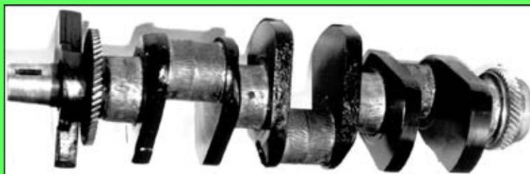
Технологический процесс восстановления состоит из следующих основных операций: предварительная термообработка для снятия усталостных напряжений, электродуговая наплавка изношенных рабочих поверхностей, повторная термообработка для снижения сварочных напряжений, механическая обработка (шлифование) наплавленных поверхностей до номинальных размеров.
