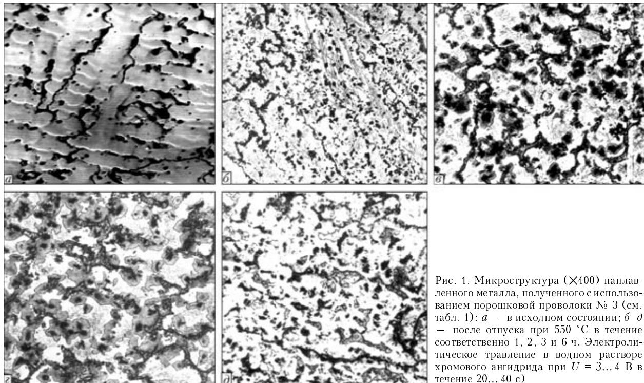
Рис. 1. Микроструктура ( $\times 400$ ) наплавленного металла, полученного с использованием порошковой проволоки № 3 (см. табл. 1): *a* — в исходном состоянии; *b—d* — после отпуска при  $550^{\circ}\text{C}$  в течение соответственно 1, 2, 3 и 6 ч. Электролитическое травление в водном растворе хромового ангидрида при  $U = 3\ldots 4$  В в течение 20...40 с)
