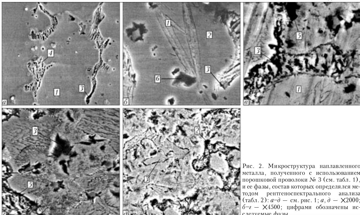
Рис. 2. Микроструктура наплавленного металла, полученного с использованием порошковой проволоки № 3 (см. табл. 1), и ее фазы, состав которых определялся методом рентгеноспектрального анализа (табл. 2): *a-d* — см. рис. 1; *a, d* —  $\times 2000$ ; *b-e* —  $\times 4500$ ; цифрами обозначены исследуемые фазы
