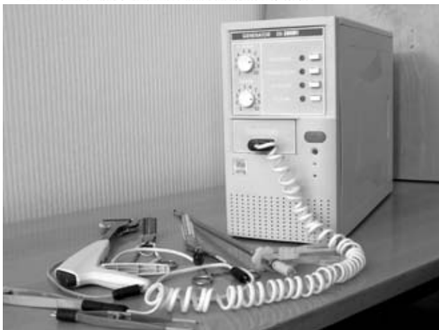
Рис. 1. Источник питания со встроенной аппаратурой управления
