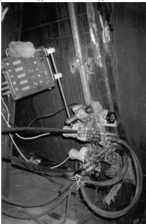
Рис. 2. Новый двухэлектродный монтажный аппарат АД-381 для электрошлаковой сварки металла толщиной 30...60 мм
