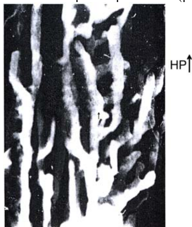
Рис. 1. Ветвление базового кристалла, ув. 25000
