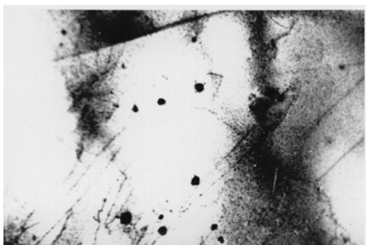
Рис. 5. Дислокационная структура Mo с 0,02 мас.% С, ув. 20000
