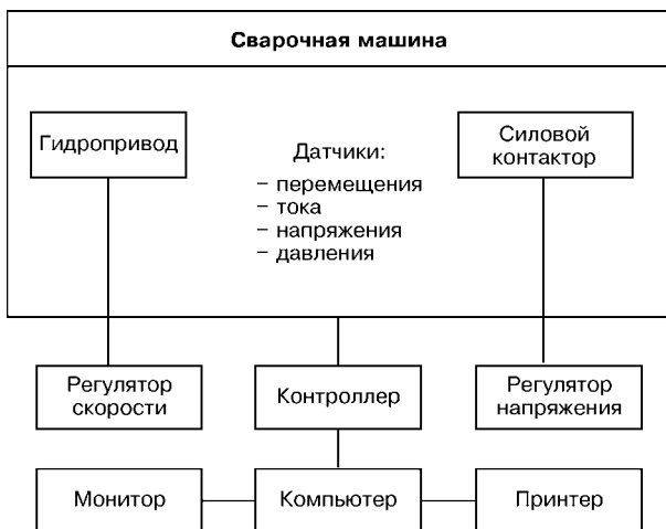
Рис. 4. Структурная схема системы контроля и управления процессом контактной сварки оплавлением
