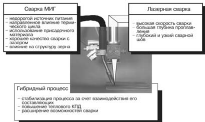
Рис. 8. Гибридная сварка (лазер-МИГ)
