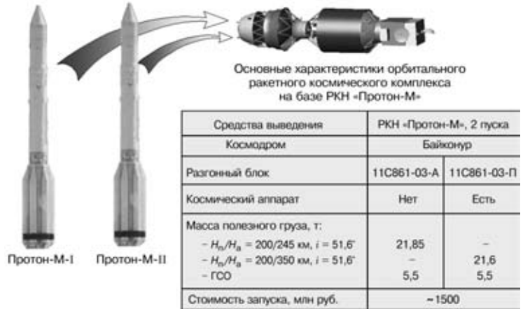
Рис. 6. Стыковка двух разгонных блоков для создания на ГСО космического аппарата массой 5,5 т
