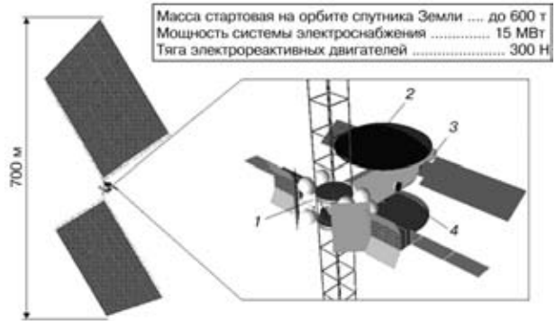
Рис. 18. Схема компоновки межпланетного экспедиционного комплекса для полета на Марс: 1 — солнечный буксир; 2 — взлетно-посадочный корабль; 3 — межпланетный орбитальный корабль; 4 — посадочный корабль
