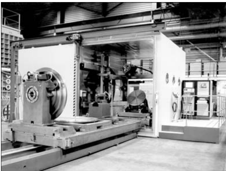
Рис. 4. Общий вид компьютеризированной установки КЛ-115 для электронно-лучевой сварки крупногабаритных изделий
