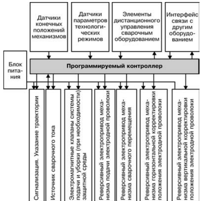
Рис. 2. Структурная схема новой блочно-модульной системы управления механизированным и автоматизированным оборудованием
