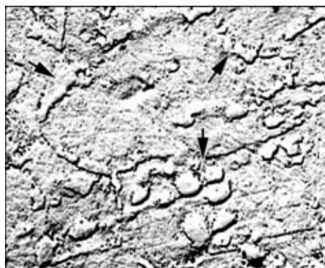
Рис. 8. Повреждаемость порами ползучести металла участка неполной перекристаллизации; углеродная реплика; ресурс эксплуатации 150000 ч; сварка на штатном режиме; основной металл 15X1M1Ф, \times 6000
