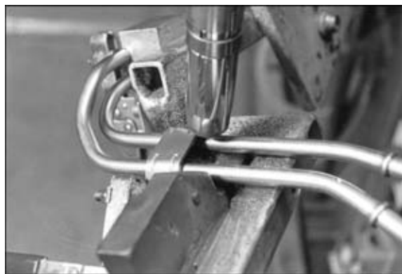
Рис. 4. Водохлаждаемая горелка Robacta Drive Twin в положении для пайки тормозных цилиндров
