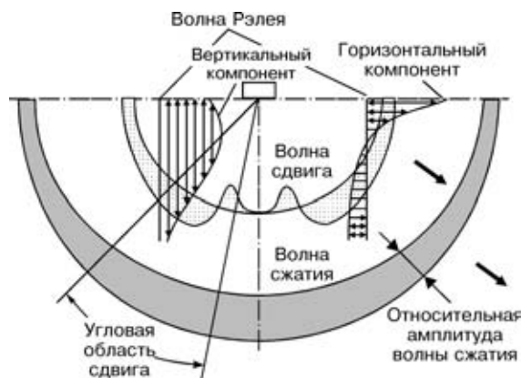
Рис. 8. Структура ударных волн в твердом теле, нагруженном узким полосовым зарядом ВВ
