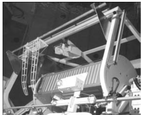
Рис. 3. Устройство, ограничивающее возможный выход руки оператора с инструментом из рабочей зоны
