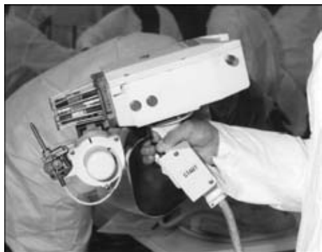
Рис. 9. Защитный экран ЭЛП ручного инструмента
