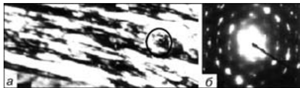
Рис. 3. Тонкая структура зоны сварки никеля ( a ), полученная сваркой взрывом при \alpha = 20^\circ , и соответствующая микродифракционная картина рефлексов ( b ), \times 15000
