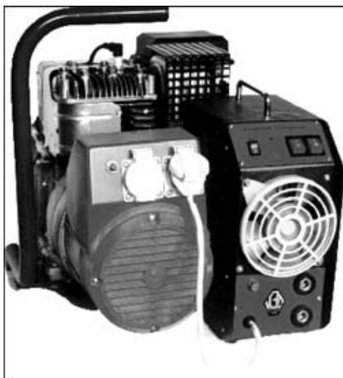
Рис. 1. Внешний вид многоцелевого малогабаритного сварочно-технологического комплекса
