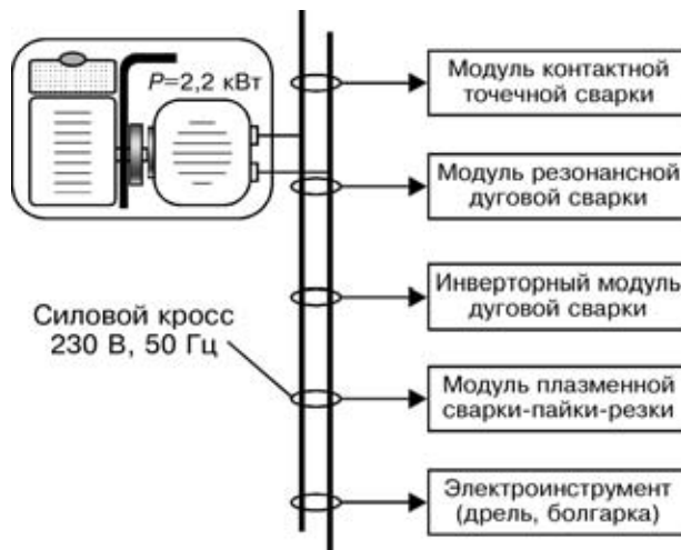
Рис. 2. Структурная схема многоцелевого малогабаритного сварочно-технологического комплекса
