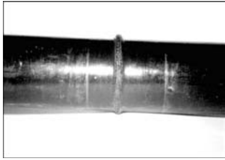
Рис. 8. Сварное соединение трубы размером 76×16 мм (время сварки 104 с)
