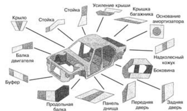
Рис. 2. Конструктивные фрагменты кузова легкового автомобиля, штампуемые из заготовок «Tailored Blanks»
