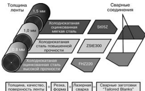
Рис. 1. Принципиальная схема производства тонколистовых заготовок «Tailored Blanks» заданных размеров
