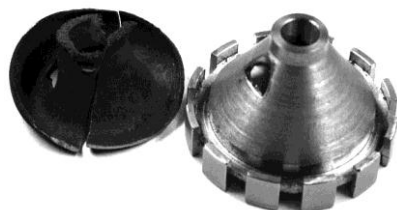
Рис. 5 – Первый конус – рассека- тель глушителя ПСУЗВ-11Т.12-5,45 после испытаний и его исходный вид
