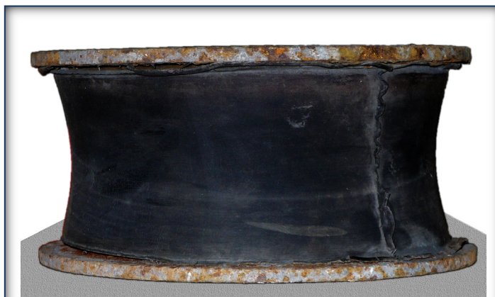
Рис. 1 – Внешний вид виброизоляторов после длительной эксплуатации
