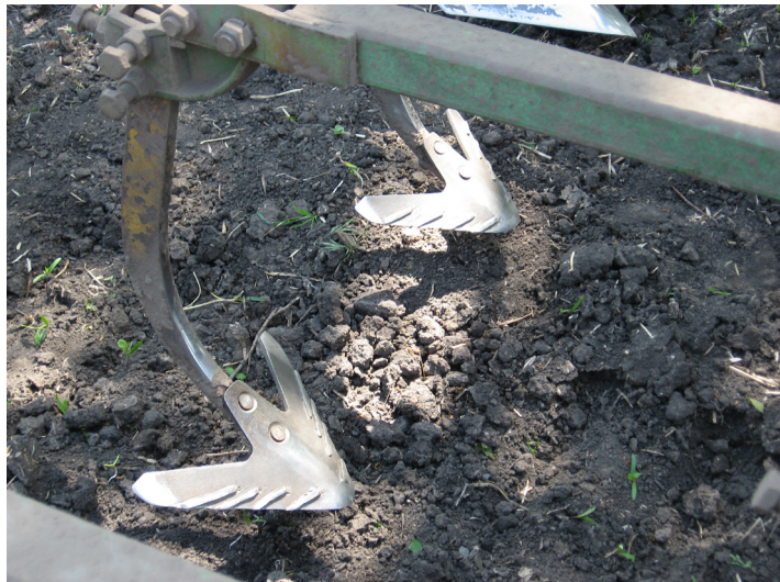
Рис. 9 – Стрельчатая лапа с элементами локального упрочнения поверхности
