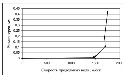
Рисунок 6 – График изменения скорости продольных волн (м/сек) от размера зерен донных осадков (мм)
