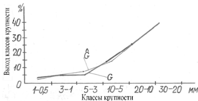
Рисунок 2 – Выход классов крупности при размерах щели 30 мм (щековая дробилка)
