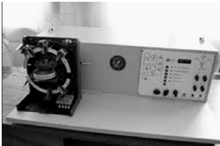
Загальний вигляд установки для дослідження процесів рідинного травлення тонких плівок
