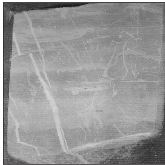
Рис. 2. Субвертикальні та горизонтальні тріщини в граптолітових аргілітах, що заліковані кальцитом з утворенням прожилково-вкрапленої мінералізації у керні за розрізом параметричної свердловини Ліщинська-1:
