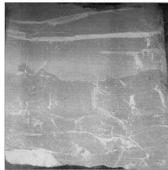
Рис. 2. Субвертикальні та горизонтальні тріщини в граптолітових аргілітах, що заліковані кальцитом з утворенням прожилково-вкрапленої мінералізації у керні за розрізом параметричної свердловини Ліщинська-1:
