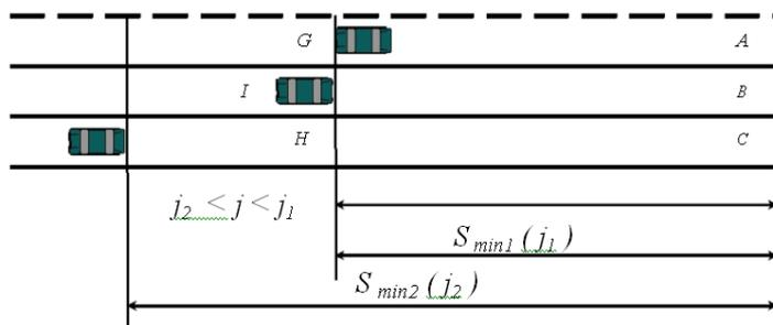
Рисунок 3 – Зона дилеммы отсутствует в случае  $(S_{max} = S_{min1}) < S_{min2}$
