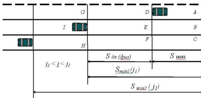
Рисунок 2 – Расположение физической зоны дилеммы в случае  $S_{max} < S_{min1} < S_{min2}$
