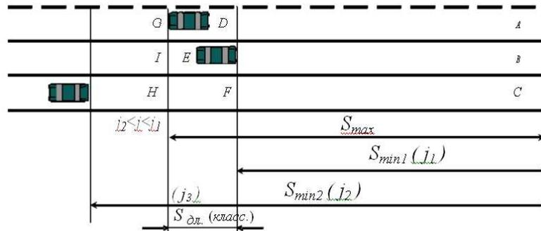
Рисунок 4 – Расположение классической зоны дилеммы в случае  $S_{min1} < S_{max} < S_{min2}$
