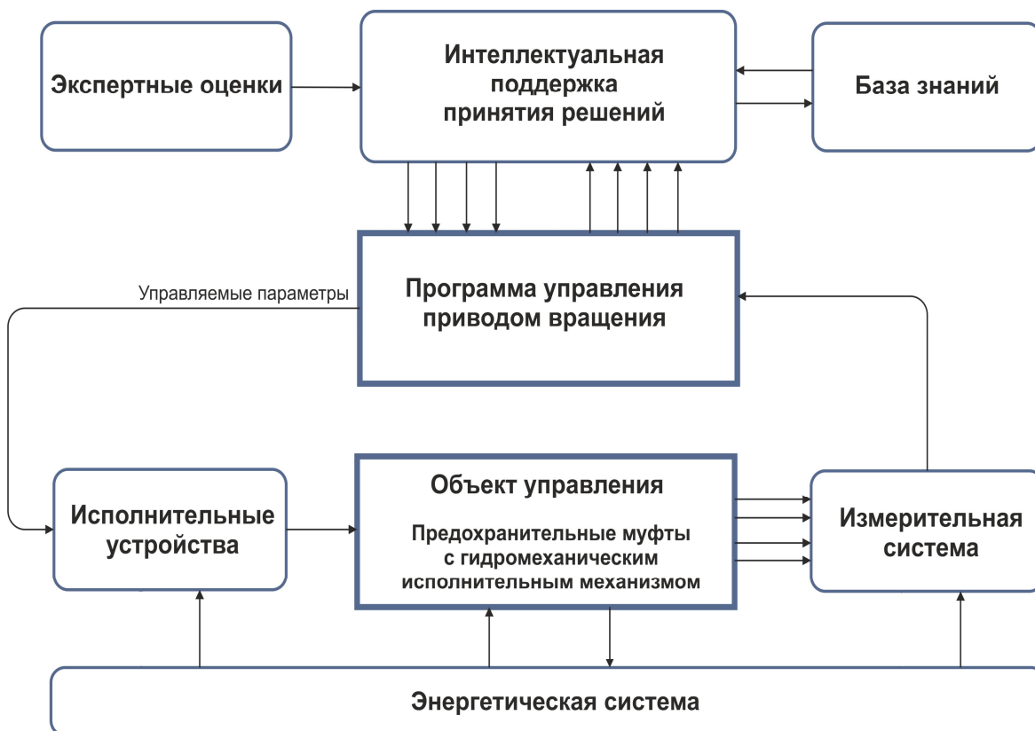
Рисунок 2 – Схема активного управления адаптивной гидромеханической муфты
