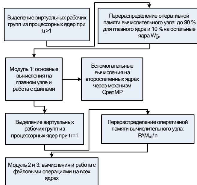
РИС. 4. Структурная схема работы программы после оптимизации
