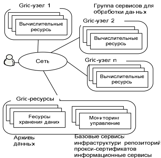
РИС. 1. Архитектура исследуемой grid-системы
