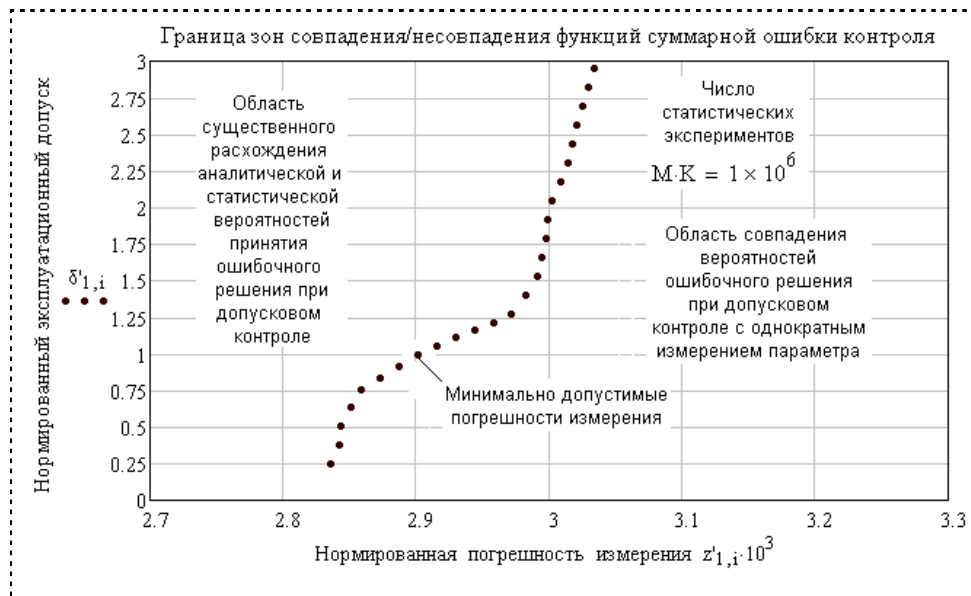
Рис. 8. Граница в координатах " \delta - z " областей совпадения и расхождения оценок \Sigma = \alpha + \beta при аналитических вычислениях и имитационном моделировании процесса контроля
