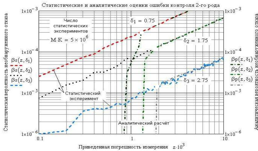
Рис. 6. Функции ошибок контроля второго рода, полученные при имитационном моделировании ( \beta_s(z, \delta) ) процесса контроля и аналитическом расчёте ( \beta_p(z, \delta) )
