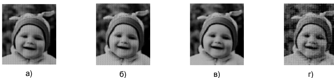
Рис. 7. Образцы изображений, восстановленных после сжатия с коэффициентом 1,98 и разрядностью выходных значений: а) 32 бита; б) 16 бит; в) 8 бит; г) 4 бита
