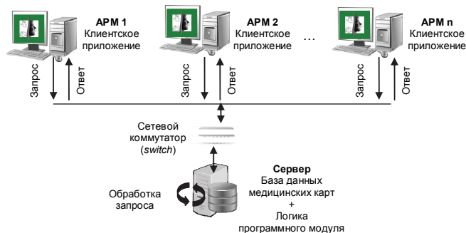
Рис. 1. Общая архитектура программного модуля технологии тренировки движений кисти для восстановления речи типа клиент–сервер
