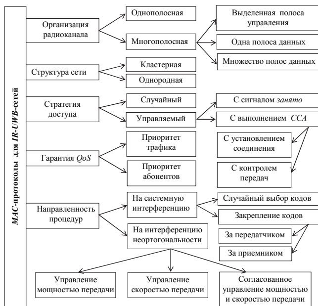
Рис. 1. Классификация MAC-протоколов для IUWB-сетей; CCA – Clear Channel Assessment (свободное состояние радиоканала)
