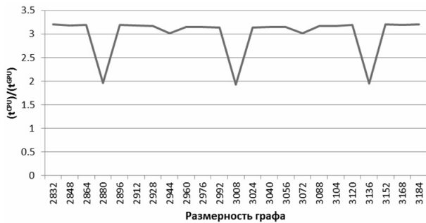
Рис. 6. Изменение отношения времени работы на центральном процессоре ( t^{CPU} ) и параллельной реализации алгоритма на видеоадаптере ( t^{GPU} )
