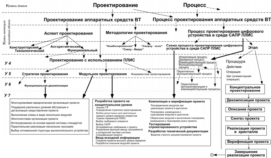
Рис. 4.а. Онтограф верхних уровней онтологии процессов ПдО «Проектирование вычислительных устройств и систем на ПЛИС»
