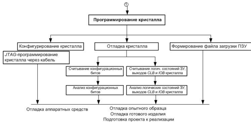
Рис. 4,б. Онтограф нижних уровней онтологии процессов ПдО «Проектирование вычислительных устройств и систем на ПЛИС»
