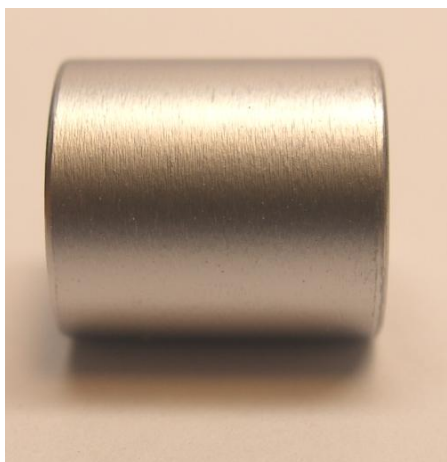
Рис. 1. Трубка из сплава Э110 с хромовым покрытием (а) и электронно-микроскопическое изображение её шлифа (б)
