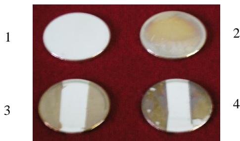
Рис. 3. Фото срібних зразків 925-ї проби після різної витримки над розчином, який містив 0.01 % мас. сульфід-йона: 1 — не було контакту; 2 — 15; 3 — 30; 4 — 60 хв. Біла смуга посередині заготовки — площа, яка була захищена від газового середовища.
