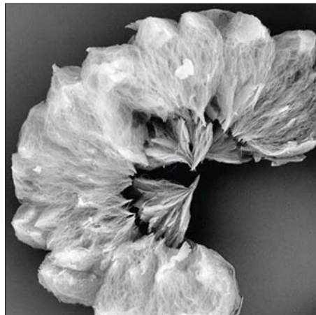
Мікроструктура наносаруватого нафтосорбенту на основі терморозширеного графіту
