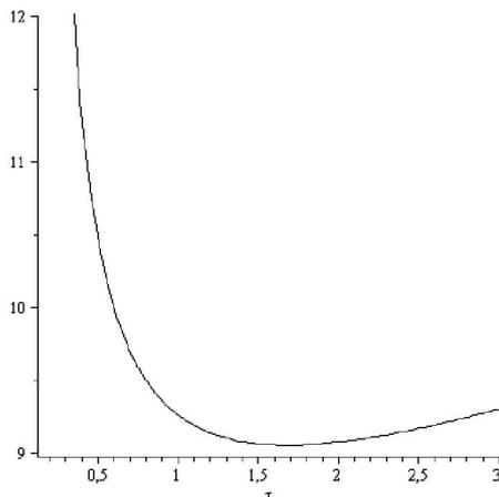
Рисунок 1 – Зависимость дисперсии априорных ошибок перед измерениями от величины длительности зондирующего сигнала ( $E = 20$ ;  $\tau_0 = 0,1$ ;  $\sigma_v = 5$ ;  $\sigma_0 = 2$ ;  $a = 1$ )
