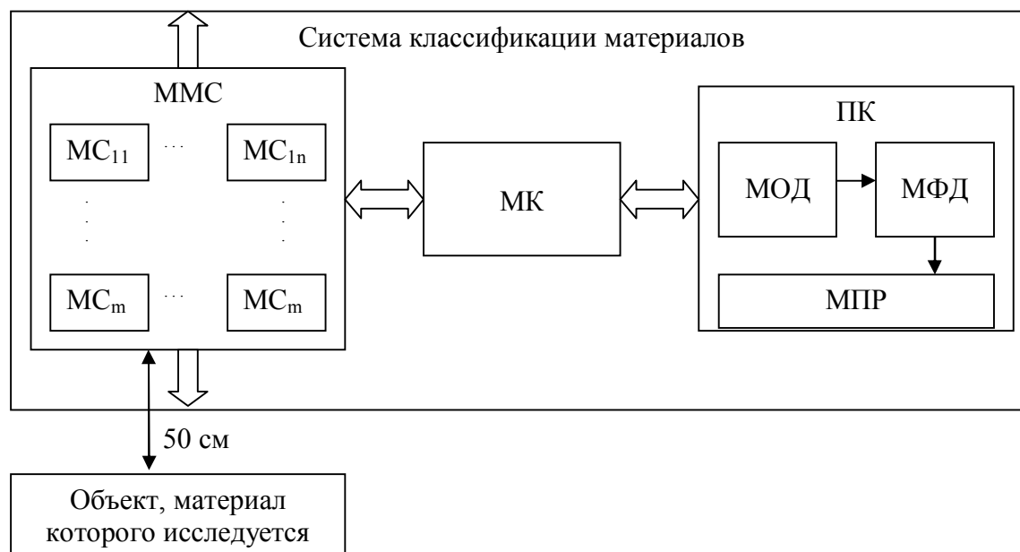
Рисунок 2 – Блок-схема стенда для получения и обработки данных с массива микроволновых сенсоров
