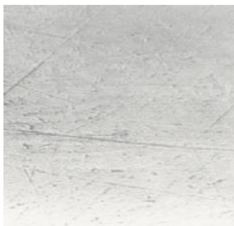
Рис. 2. Полировка (в течение 1 мин (а) и 3,5 мин (б)) на бильярдном сукне и алмазной пасте 1/0 поверхности шлифа трубы из сплава Э-110, x200
