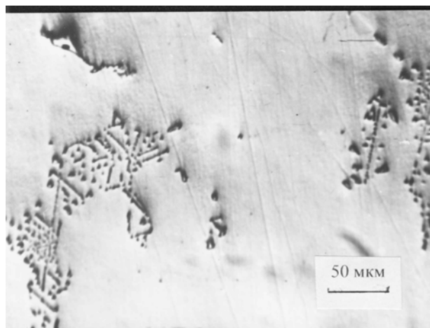
Рис.5 Морфология карбидов в монокристаллах сплава ЖС 32-ВИ
