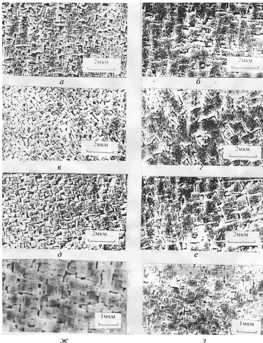
Рис.8. Микроструктура сплава ЖС32-ВИ в литом состоянии:
