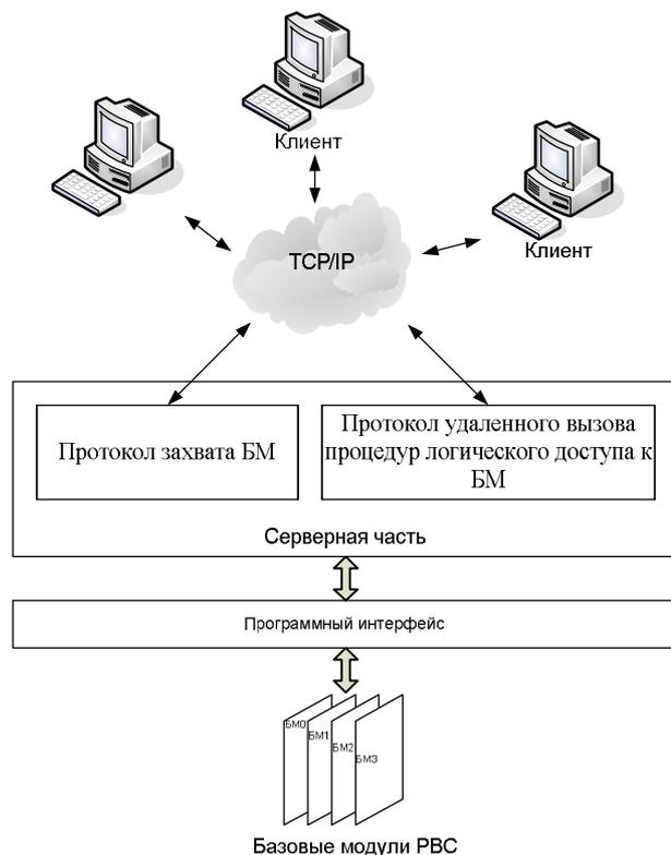
Рисунок 6 – Структурная схема системы удаленного доступа
