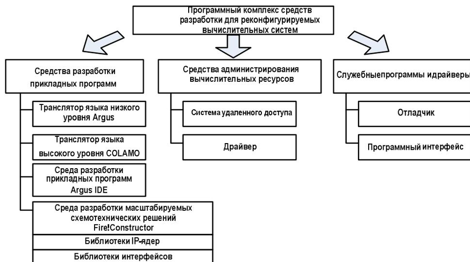
Рисунок 1 – Структура программного комплекса средств разработки для РВС
