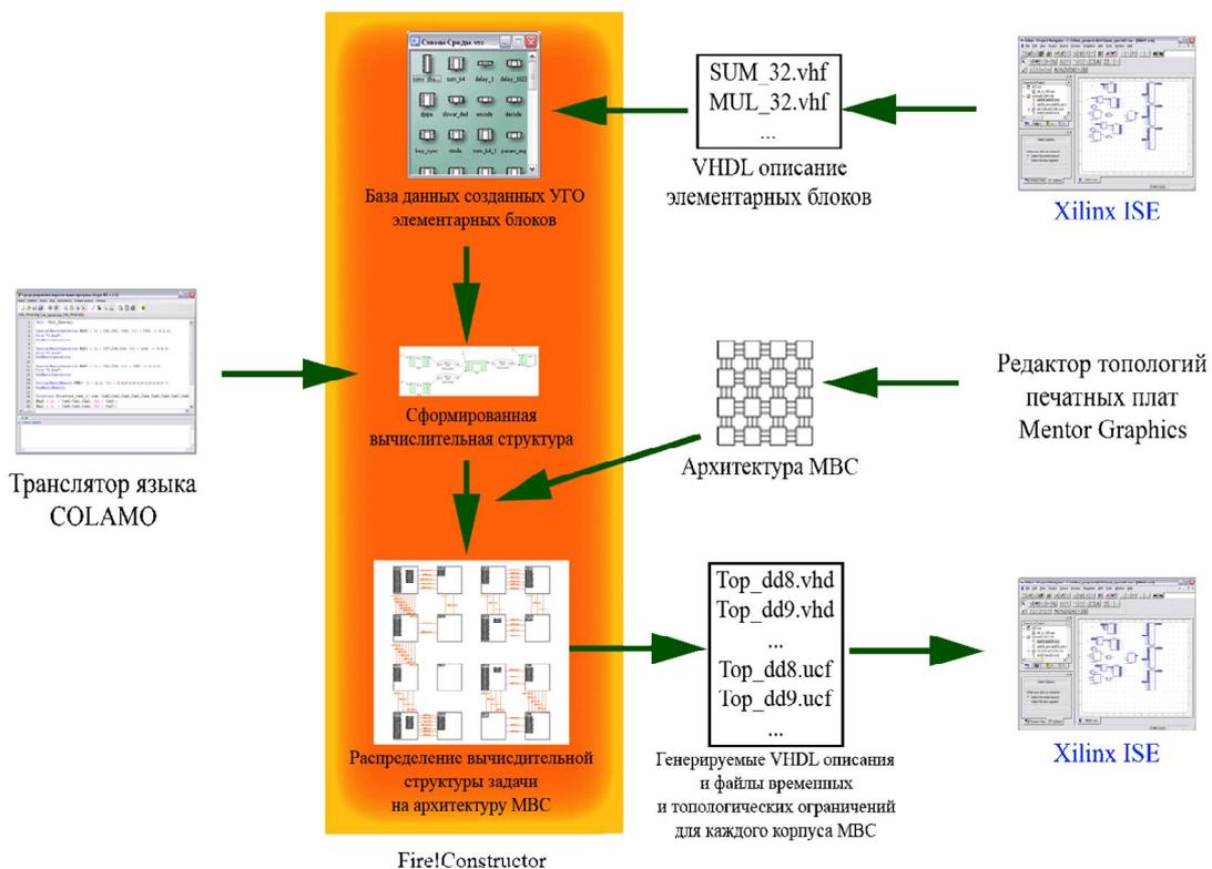
Рисунок 5 – Взаимосвязь компонент комплекса при создании многокристального схмотехнического решения для базового модуля PBC
