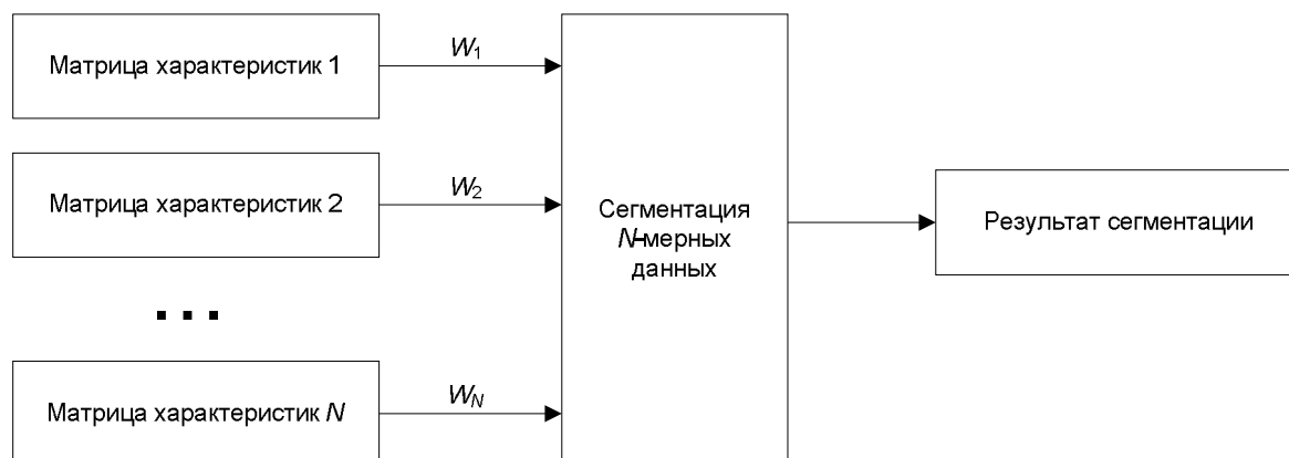
Рисунок 6 – Схема алгоритма совместной сегментации ( W_i – весовой коэффициент)
