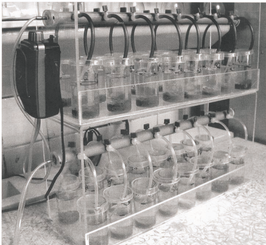
1. Экспериментальная установка для оценки токсичности донных отложений и воды.
