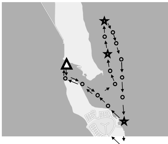
Рисунок 5 – Пример траектории движения робота при взятии проб в нескольких точках: ▲ – база, ★ – точки, в которых осуществляется взятие проб воды, ○ – заранее заданные точки, через которые должен пройти робот
